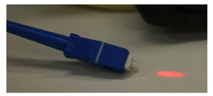
Figure 1.1.4-1 Visual Fault Locator (VFL)
