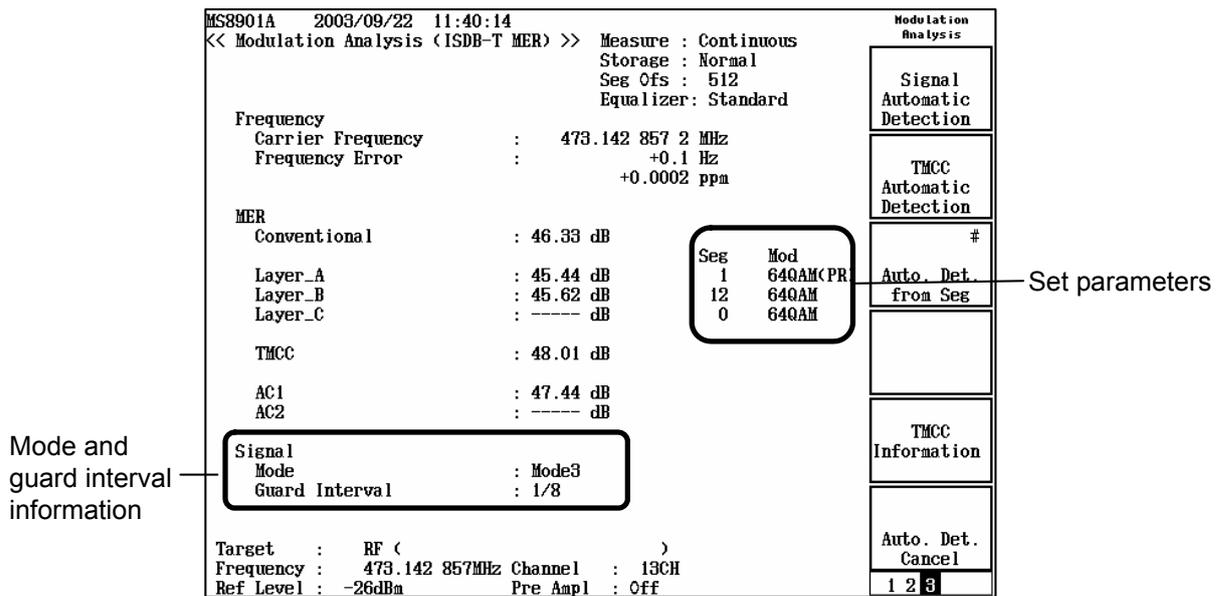
Figure 2.10.2-1 Detected parameters display
