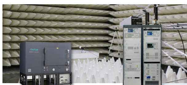
CATR Anechoic Chamber MA8172A
