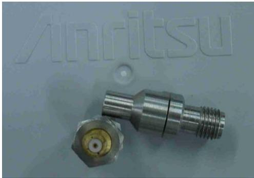
Figure 4.5: SMA-SMP Adapter
