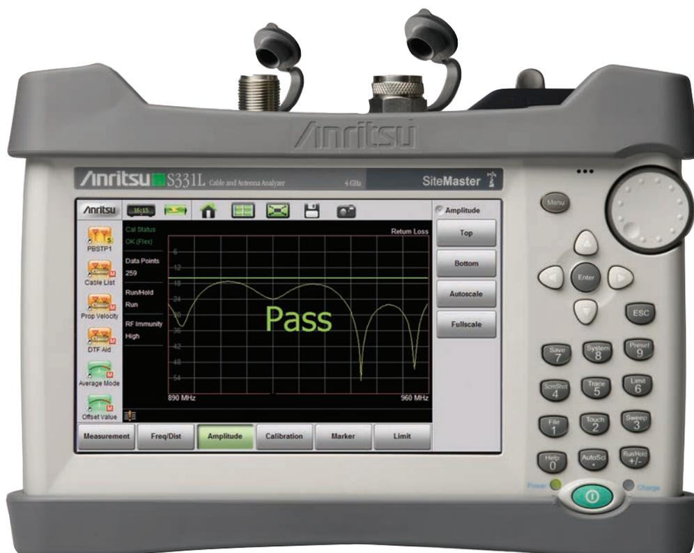
昼光下で読み取り可能な7.0インチタッチスクリーンを搭載したサイトマスタ™ S331L ケーブル/アンテナアナライザ
