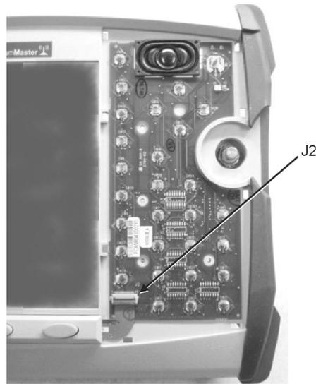
**Figure 23.** Keypad PCB
