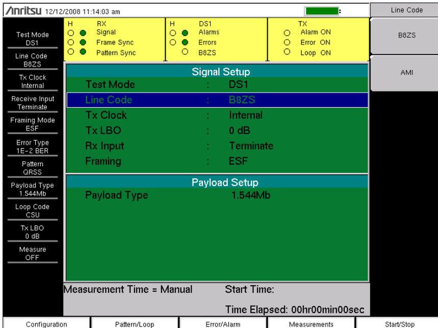
**Figure 5-6.** T1 Signal Setup for DS1
