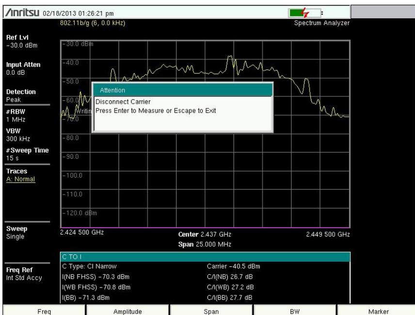
図 2-9. C/I 測定、測定されたキャリア
