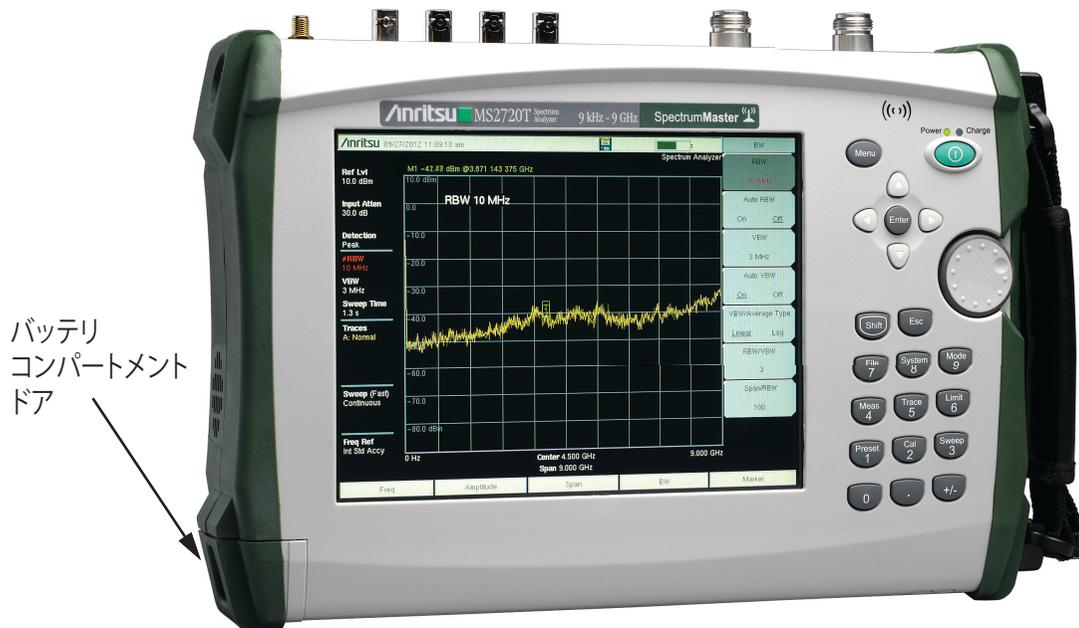
図 1-1. バッテリーコンパートメントのドア
