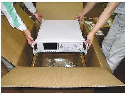
1. フィルムを張って組み立てたフレームを箱に入れ、中心に製品を置きます。
