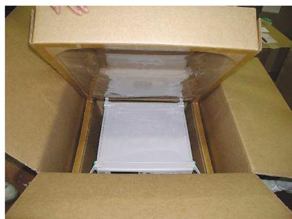
2. もう一方のフレームで蓋をし、製品を2枚のフィルムで挟みます。
