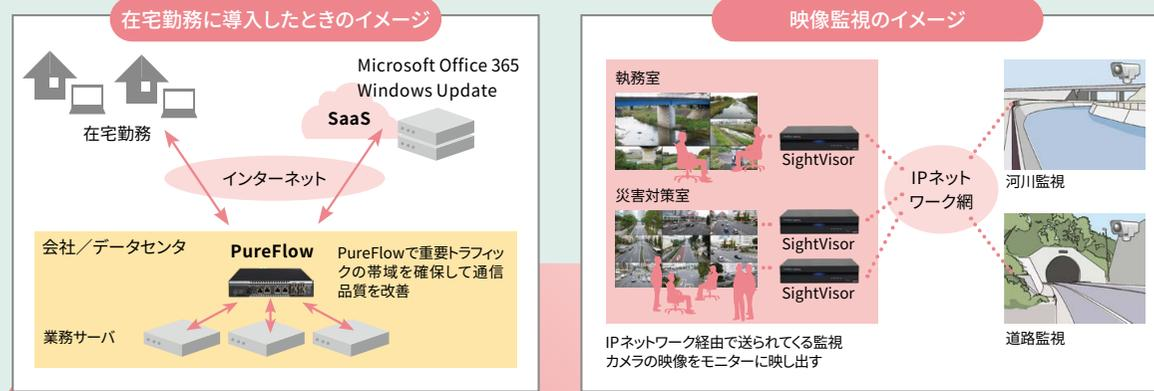
PureFlowWS1を導入し、通信帯域の優先制御を行うことで、在宅勤務者の増加による業務サーバへのアクセス不安定を解消する。
