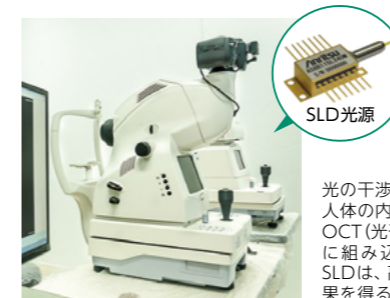
眼科OCT (網膜断面観測装置)
