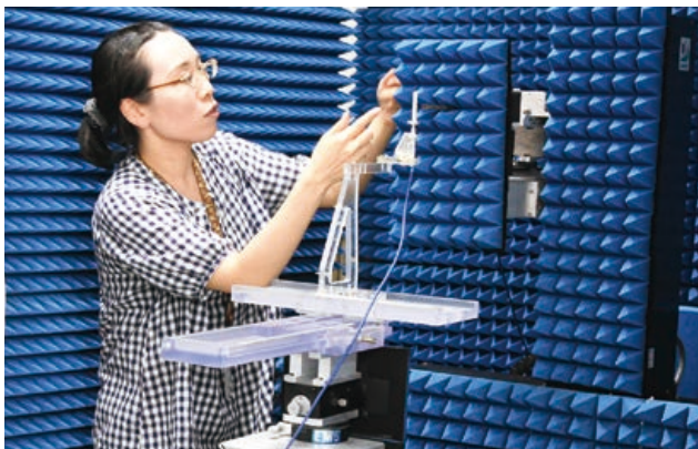
OTA測定技術の一例：Massive MIMOアンテナの近傍界測定
