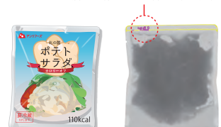
かみこみ検査 食品のパッケージのシール部分に、内容物がかみこんでいないかを検査します。
