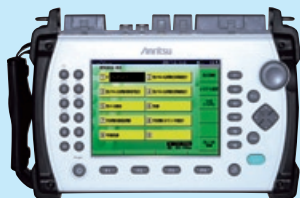
光ファイバ用計測器 (光ファイバの破断点、障害箇所を高精度に測定できる計測器)
