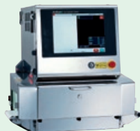
X線異物検出機 （食品に紛れ込む金属、骨、石などを検出する機器）
