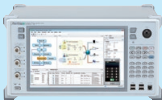
LTEシグナリングテスタ (3G/LTE疑似基地局として動作し、通信機能・各種アプリケーションの接続性を検証できるシミュレータ)
