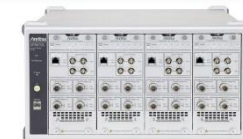
ワイヤレス通信 RF性能試験
