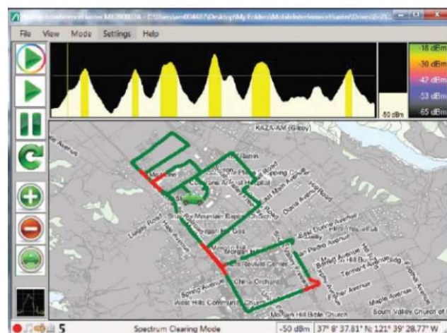
図 22. MX280007A を使ったスペクトラム クリアリング
