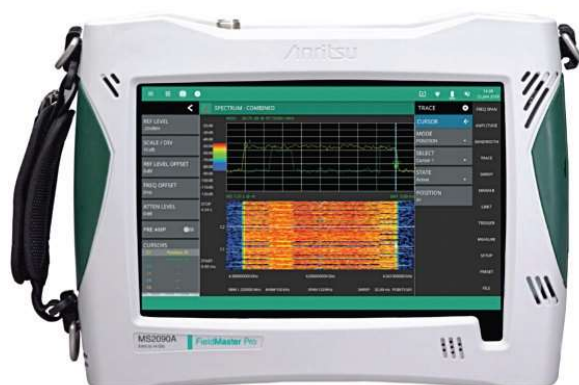
図 14. フィールドマスタ プロ MS2090A リアルタイム スペクトラム アナライザ
