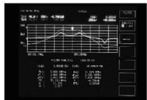
フィルタ機能による測定
