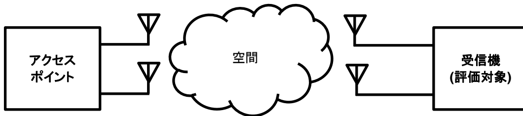
図 4. 実環境での試験ブロック図
