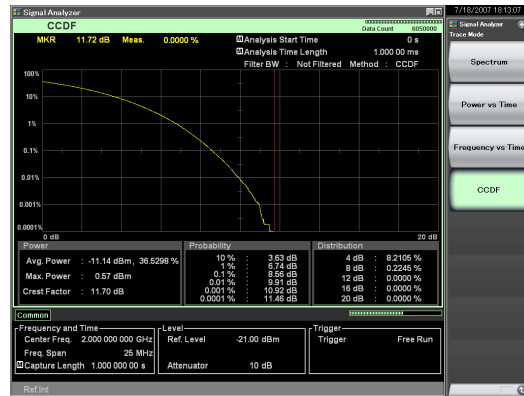
図: CCDF解析画面例 (W-CDMA, TestModel1 64DPCH x 4キャリア, 2GHz)
