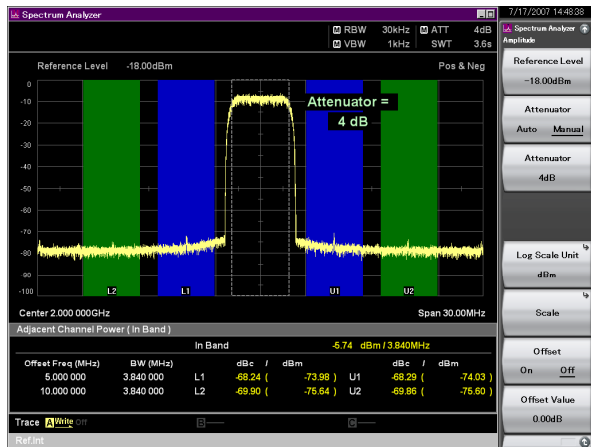
図: ACLR性能(実測値) (W-CDMA, TestModel1 64DPCH, 2GHz, SG出力 -5dBm)
