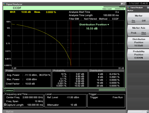
図: CCDF解析画面例 (W-CDMA, TestModel1 64DPCH, 2GHz)
