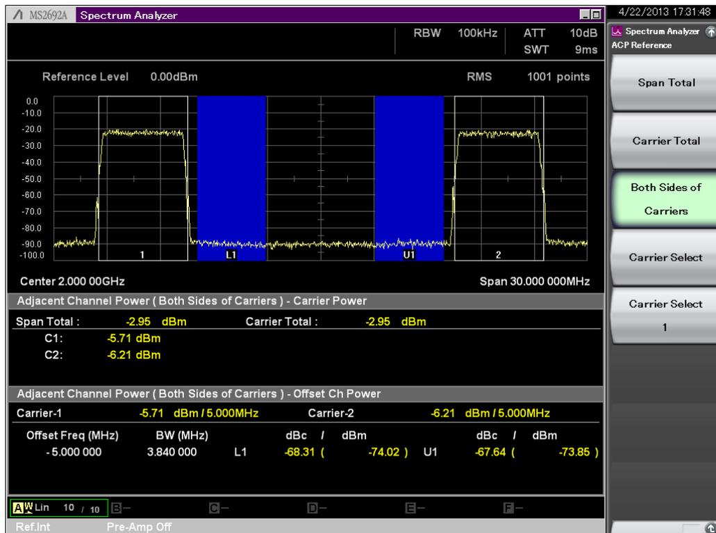
図 15. 不連続スペクトラムの ACLR(サブブロックギャップの内側)の測定例
