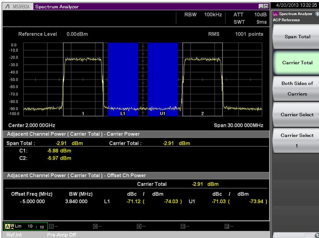
図 13. 不連続スペクトラムの CA CLR(サブブロックギャップの内側)の測定例
