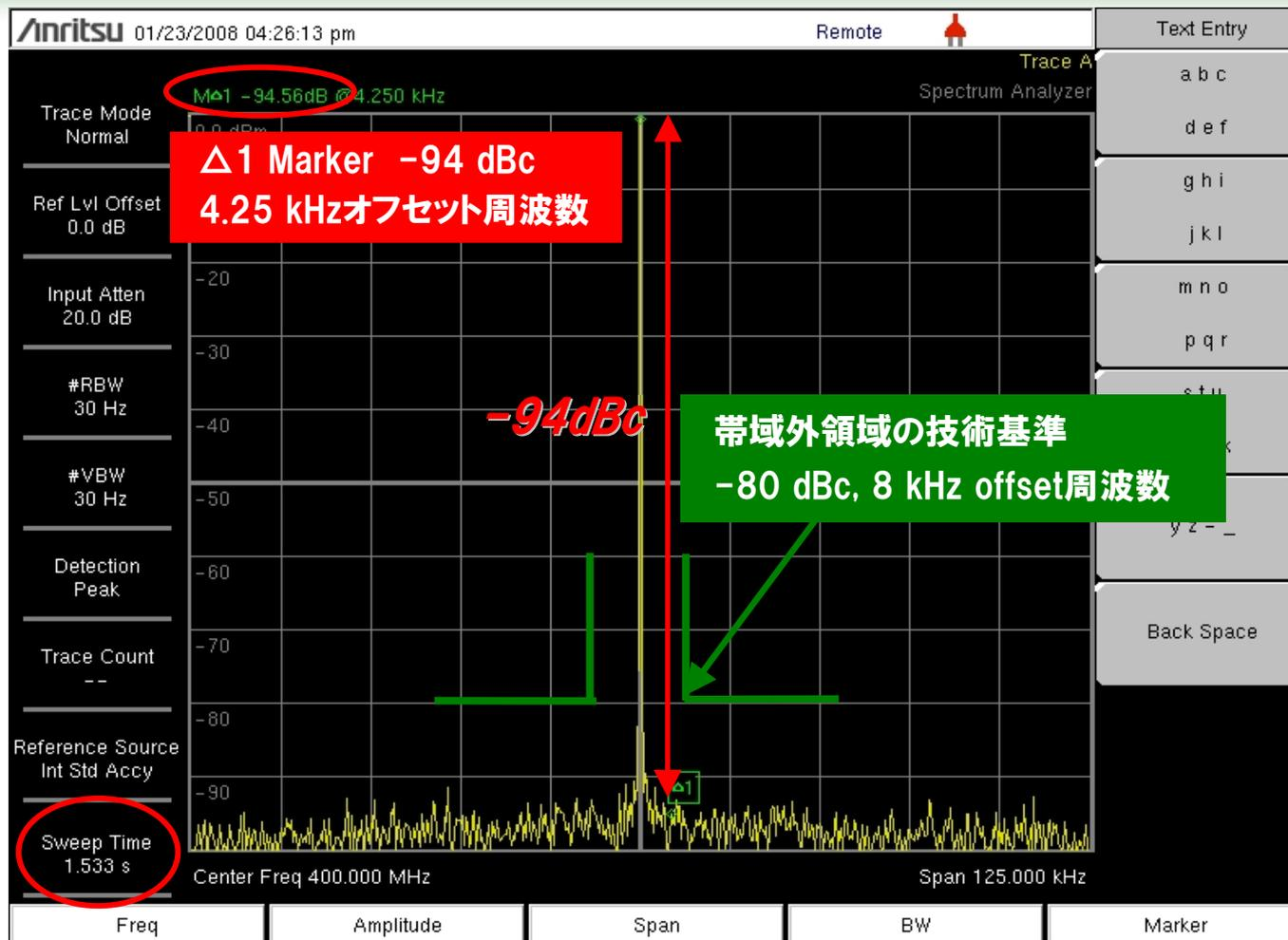
8 kHzオフセットにおけるダイナミックレンジは-94 dB/30 Hz
