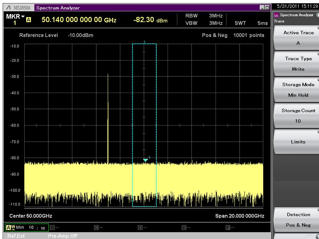
図7. Signal ID: ON時にMin Holdを設定した47 GHzの信号の測定例
