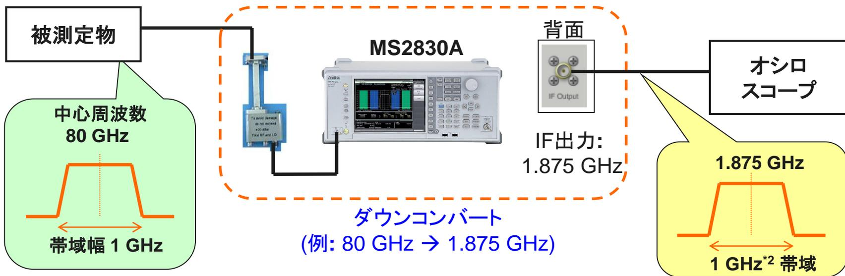
図8. 中心周波数 80 GHz, 帯域幅1 GHz\* の信号を1.875 GHzにダウンコンバートした使用例
