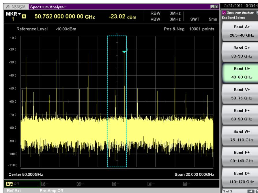
図3. MA2473Aによる47GHzの信号の測定例
