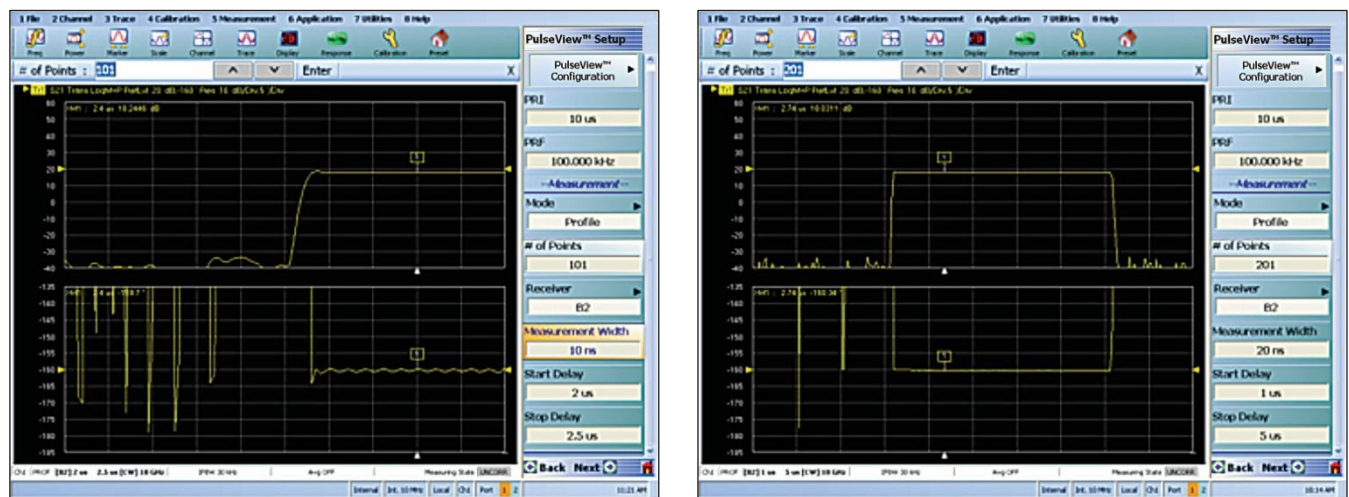
(a) パルスのリーディング・エッジを調べるプロファイル測定
