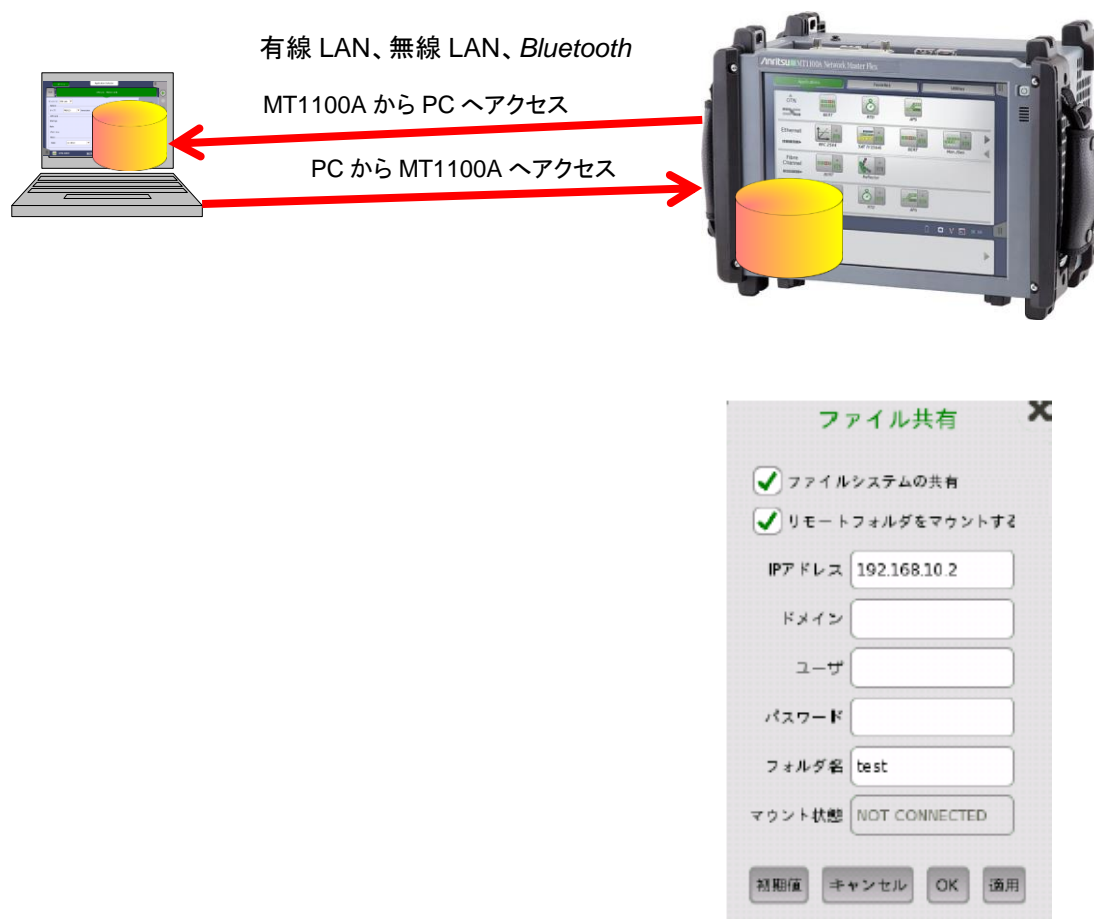
図 4. MT1100A 内蔵ファイルサーバを使ったファイル転送
