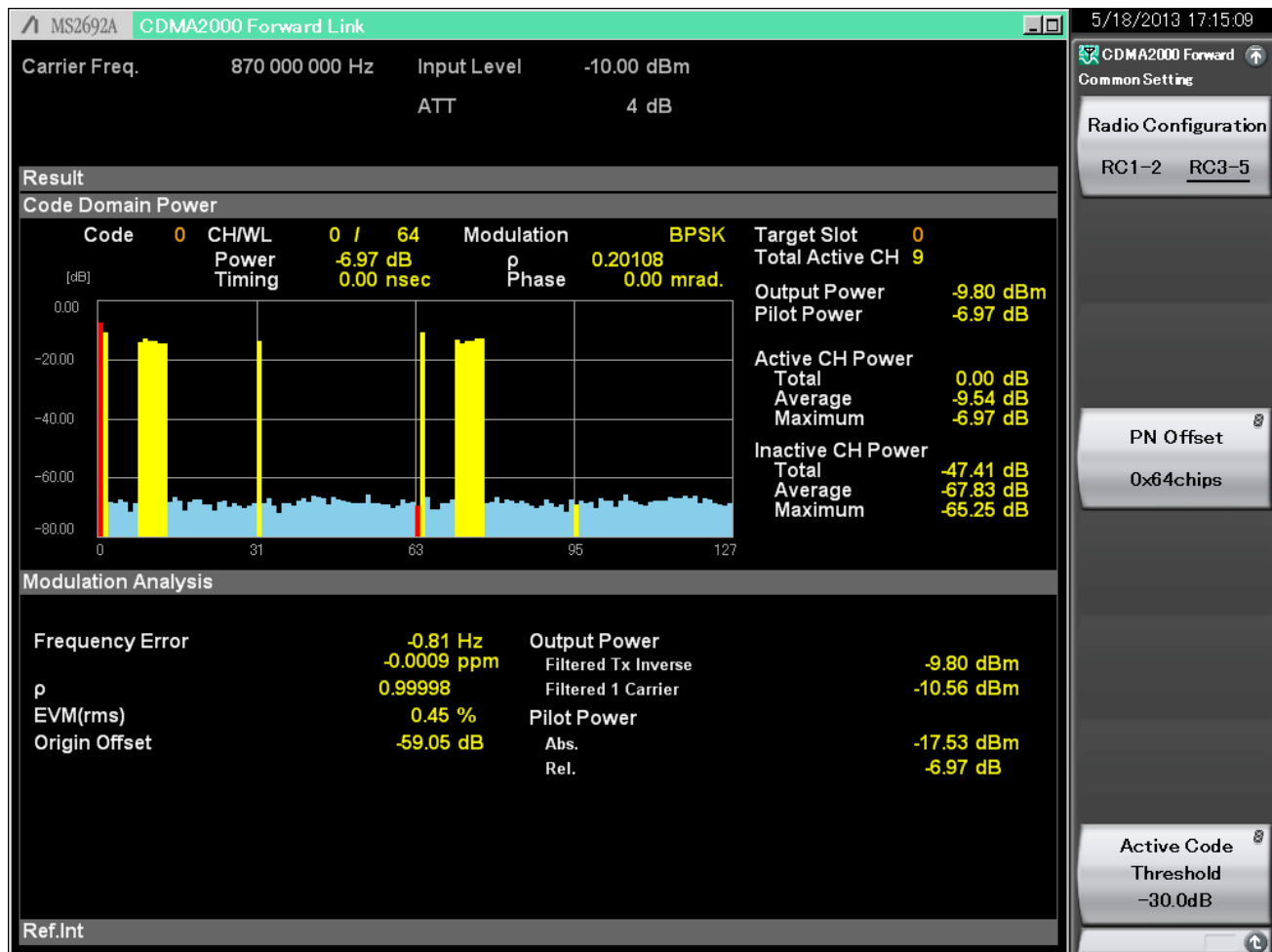
図 3. 周波数誤差・変調精度・コードドメインパワーの測定結果例
