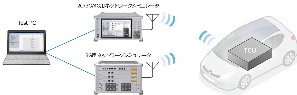
図7 シミュレータを使用したTCUの試験
