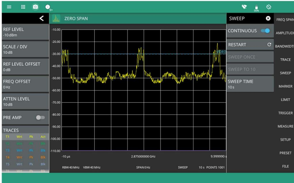
図 6. 10 秒のタイムスパンを設定すると、レーダーアンテナが回転し、MS2090A に向けられたパルスバーストが測定されます。
