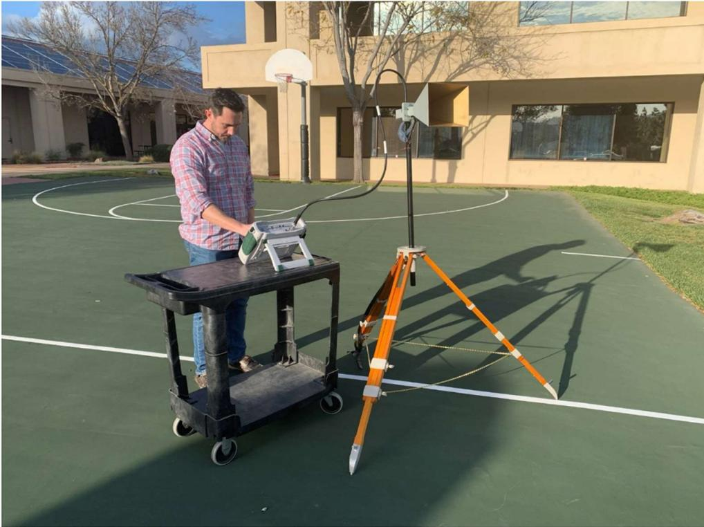
図 1. FAA レーダーのパルスを測定するためのセットアップ（導波管ホーンアンテナと MS2090A）
