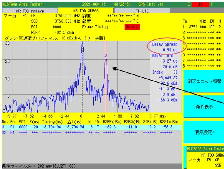
直接波と建物の反射などで遅れてくるフレーム（マルチパス）がCP長以上に遅れると干渉を起こします。干渉を起こすと、受信信号がエラーになります。
