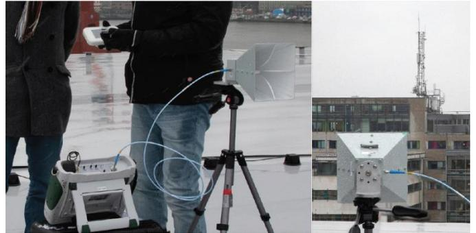
クワッドリッジホーンアンテナを用いた置局後基地局の実測例
