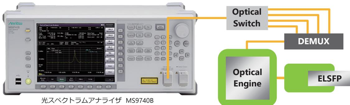
図6 : Optical Engineの光スペクトラム測定 (400GBASE-FR4)
