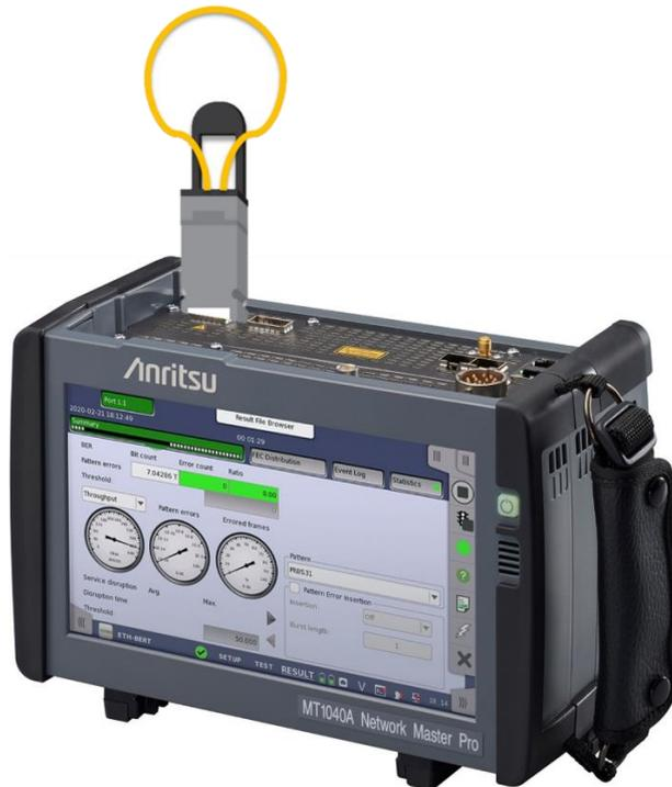
図 16 ループバック光トランシーバの検証
