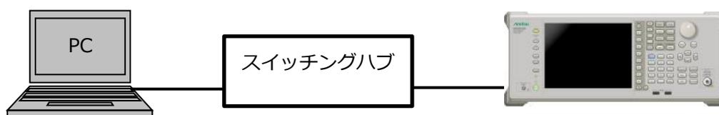
図3 ローカルエリアネットワークの最小構成例
