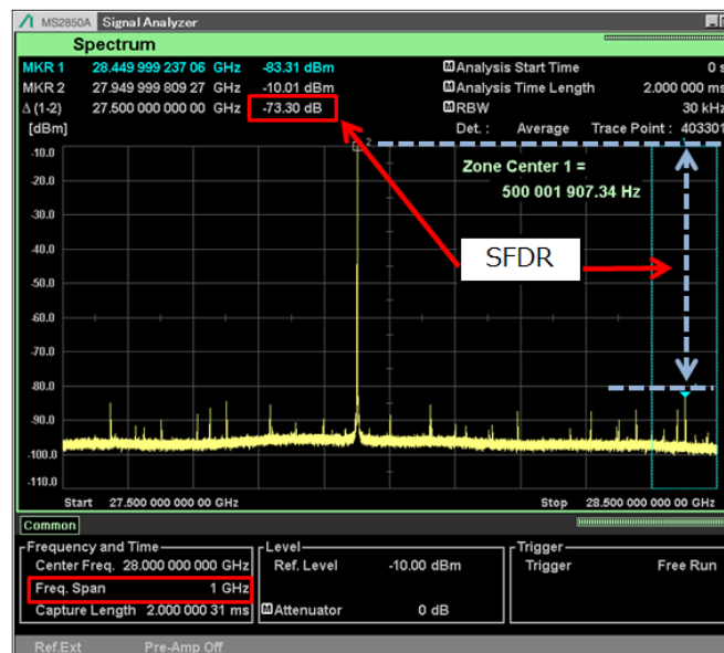
図 4.1-1 SFDR の実測例（中心周波数 28 GHz、スパン 1 GHz、実測値）
