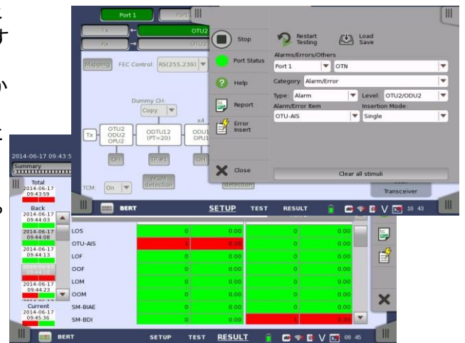
図 3. デュアルポート BERT におけるアラームの挿入と検出
