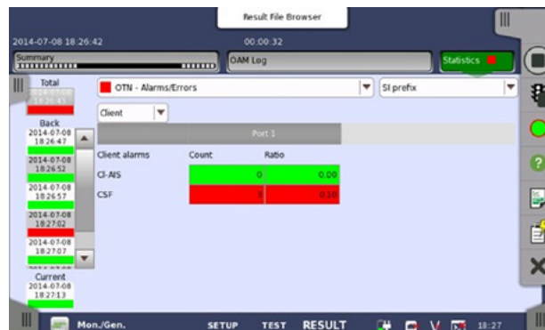
図6 高いレベルのレイヤが原因のCSF アラーム
