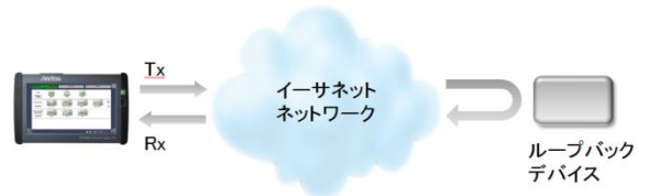
図 5. ループバックデバイスを使ったラウンドトリップ試験
