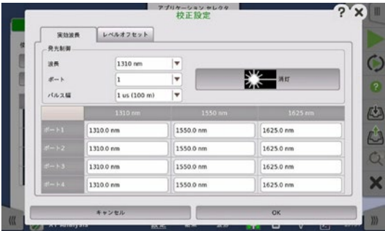
測定用光パルスの設定と実効中心波長の入力
