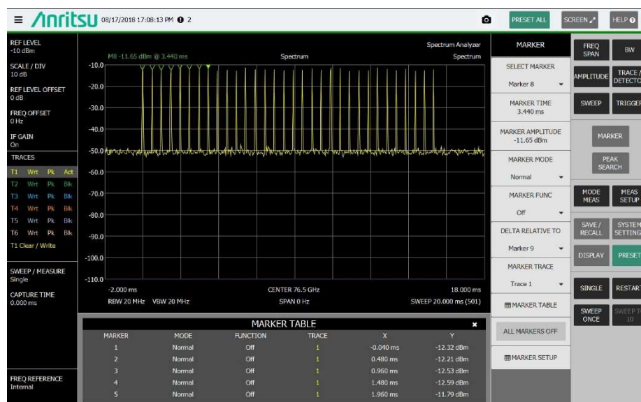
図 15: ゼロスパンの FMCW フレームを拡大すると、フレーム内のチャープ数が判明します
