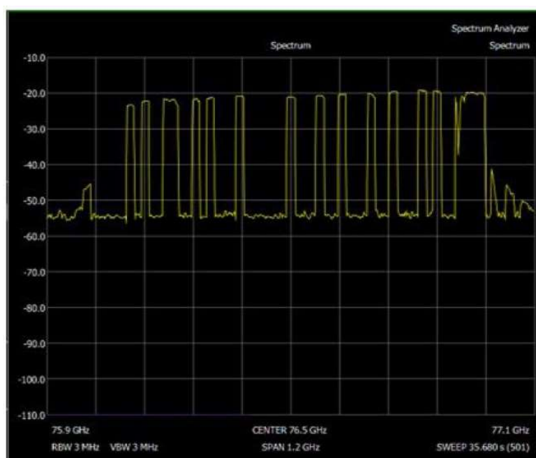
図 7: スペクトラムアナライザでの FMCW 信号の測定におけるドロップアウトの例（振幅 - 周波数）
