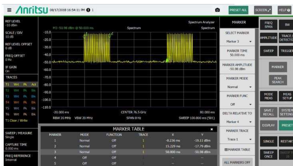
図 14 : ゼロスパンで見る FMCW チャープフレーム
