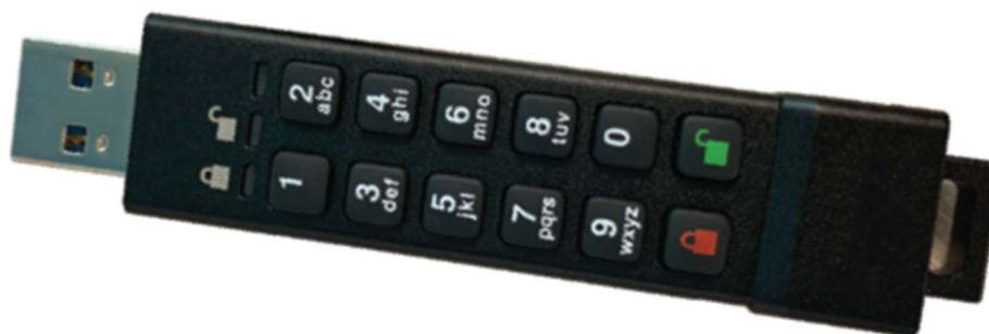
図 1. AES 256 ビット暗号化を搭載した FIPS 準拠の標準的な USB メモリ
