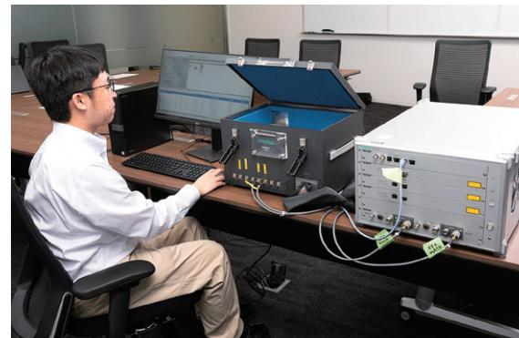
5G基地局シミュレータ「MT8000A」による端末機能試験。MT8000A(右側)から電波を発信し、シールドボックス「MA8161A」(中央)に格納された5G端末と呼接続して、モニター上のGUI操作で各種機能を確認する。
