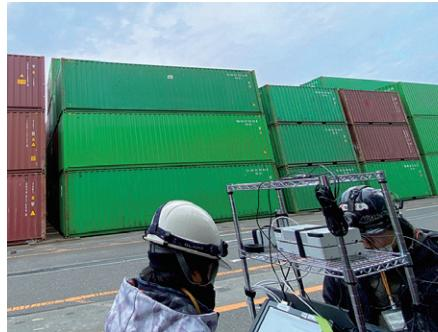
大阪・夢洲コンテナターミナルで行われたMT1000Aによる電波伝搬状況の評価。実際の広範なフィールドを移動して、高精度な計測データが得られた。
