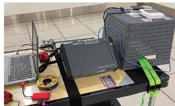
2台のうちサーバールーム側に設置されたMT1000A。もう1台は移動端末側に設置されており、ローカル5GのEnd to Endの評価検証が可能になっている。
