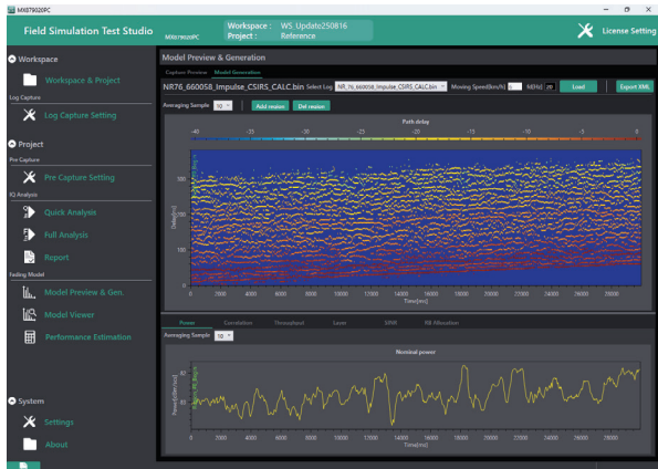
FSTで収録した電波の伝搬特性解析の例。グラフ上段が解析した伝搬遅延プロファイル、下段がスループットの時間変動を表す
