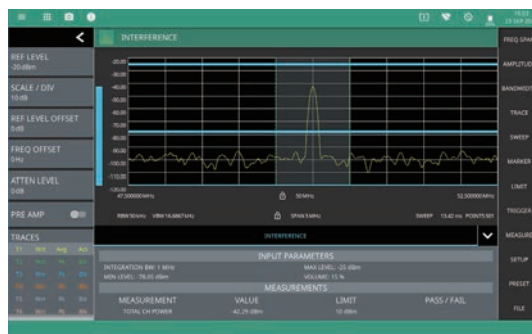
インターフェアレンスファインダー オプション24 干渉波レベル変化に応じたトーン音応答
