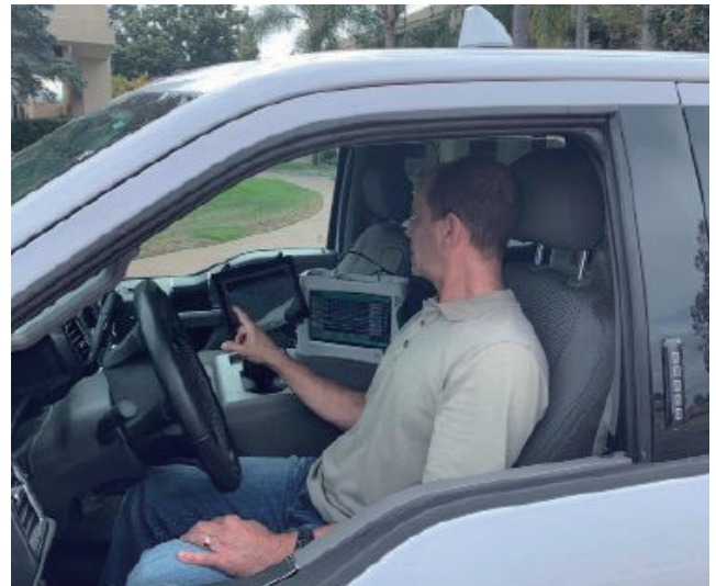
MIH システム : 車両に大型ディスプレイ、およびルーフに全方向性アンテナを設置
