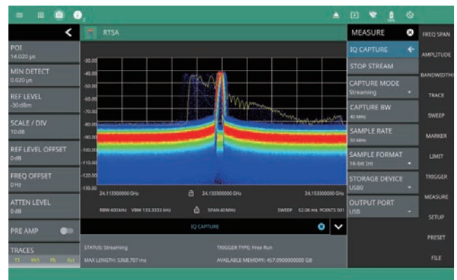
RTSA のデータ更新と IQ データストリーミングを並行して実施
