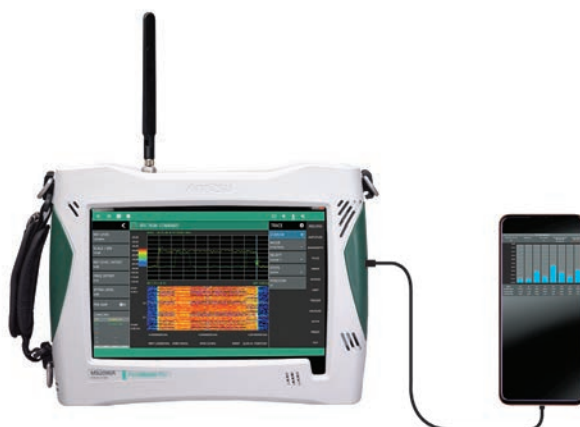
AndroidスマートフォンでMS2090Aを制御
