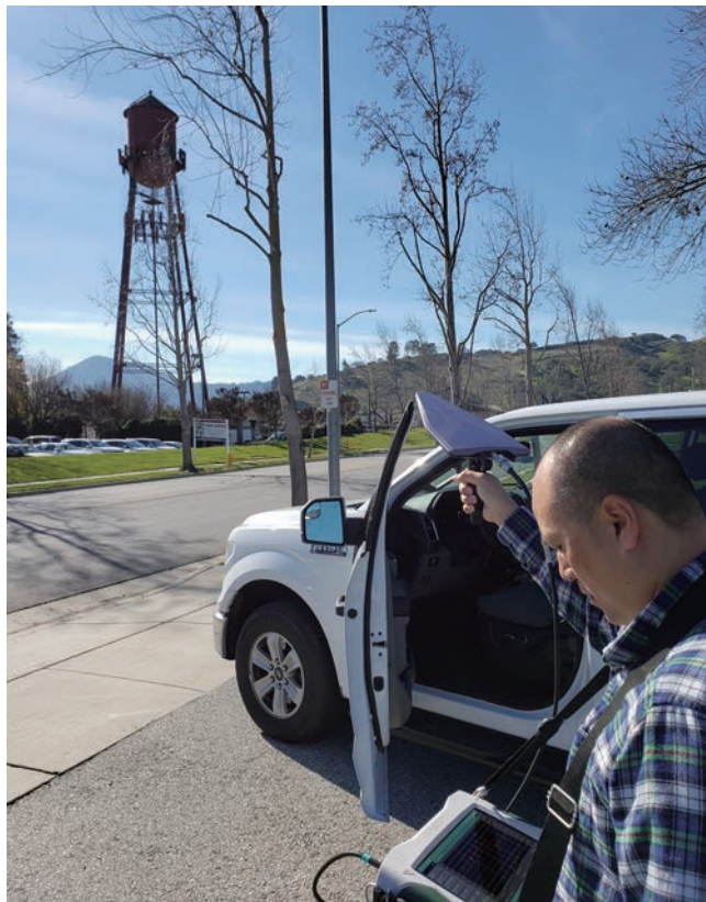
MS2090Aは指向性アンテナを使用して、干渉源の位置を容易に特定します。
