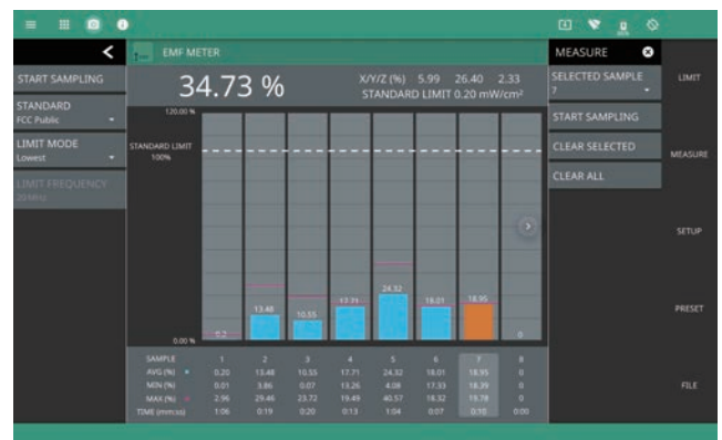
EMF メータ : ICNIRP 制限値のパーセンテージで 経時変化を表示 (1 サイトで最大 16 箇所)
