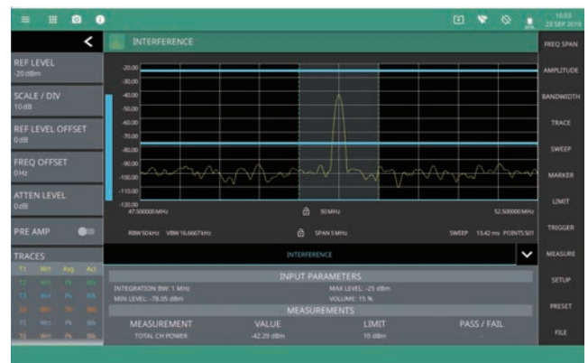
オプション0024 インターフェアレンスファインダー： 干渉波のレベル変化に応じたオーディオトーン
