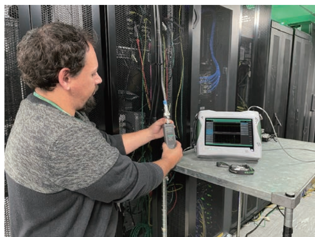
ポケットサイズの S331P は、延長ケーブルを使用せずに 試験対象ケーブルに直接接続できます
