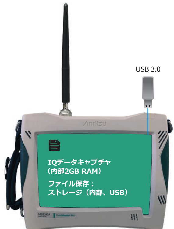
RTSA とスペクトログラム同時表示： 信号をより詳しくモニタリング
