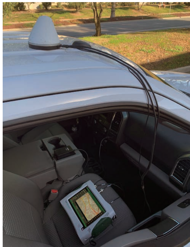
車両走行無線カバレッジマッピング MS2090A とアクセサリのマグネット式アンテナ
