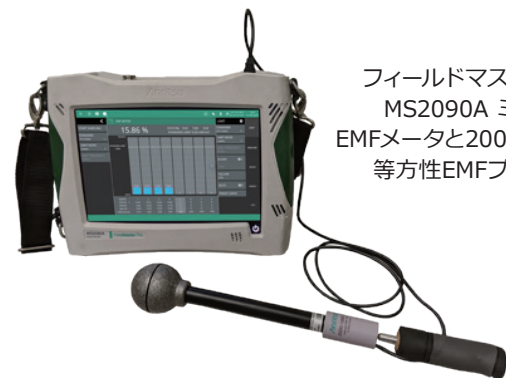
EMF の結果表示 : 各アンテナ軸からの電力および 定義時間でのピーク電力と平均電力のサマリ
