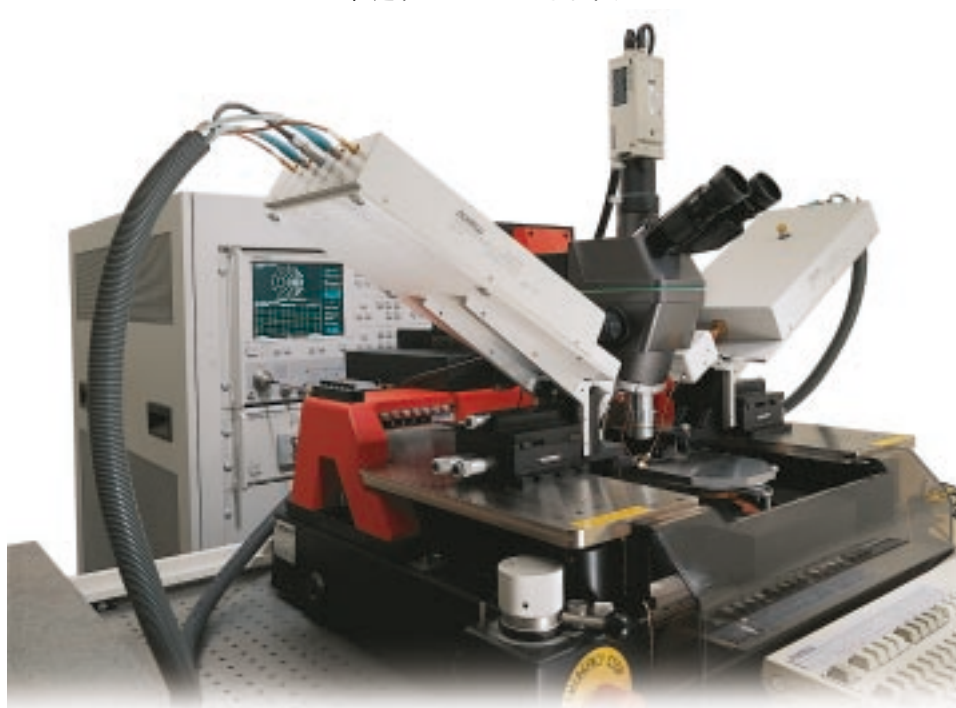
ME7808Cを使用した500GHzまでのオン・ウエハ測定
