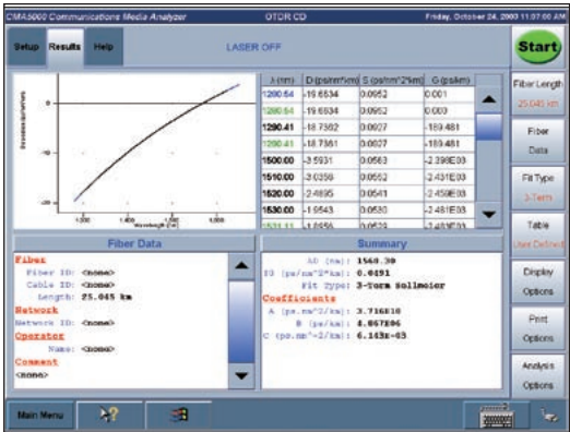
CD-OTDR のわかりやすい結果表示画面
