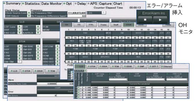
GMP (Generic Mapping Procedure) を使用して、イーサネットクライアント信号をOTU4信号にマッピングすることで、より運用に近い状態での検証ができます。
