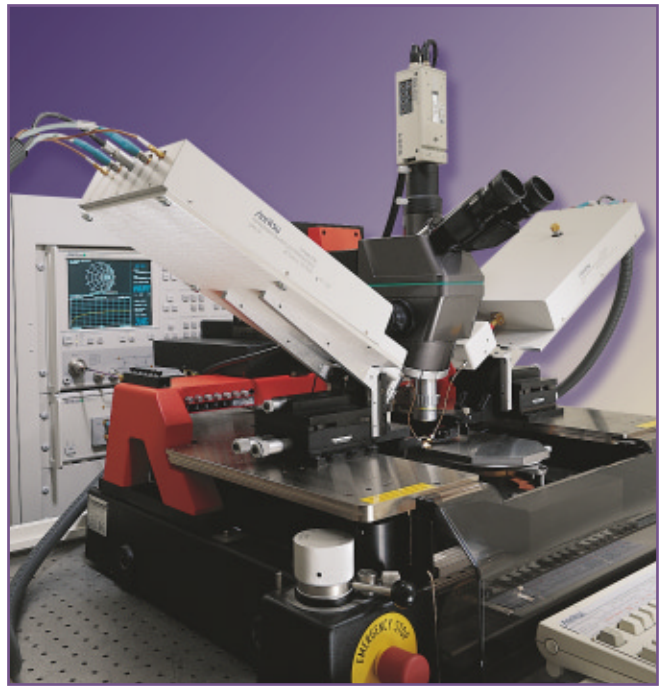
完全なオン・ウェーハ測定ソリューション：Karl Suss PA200 プローブシステムと統合したME7808A
